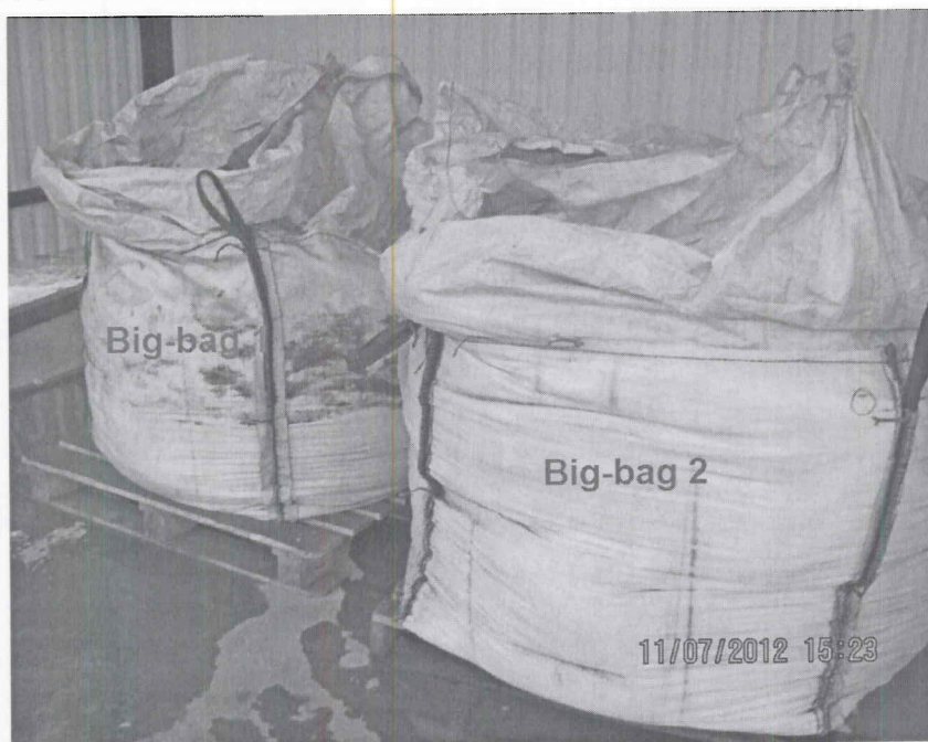
Foto 6. Big-bags almacenamiento del residuo CALAMINA
